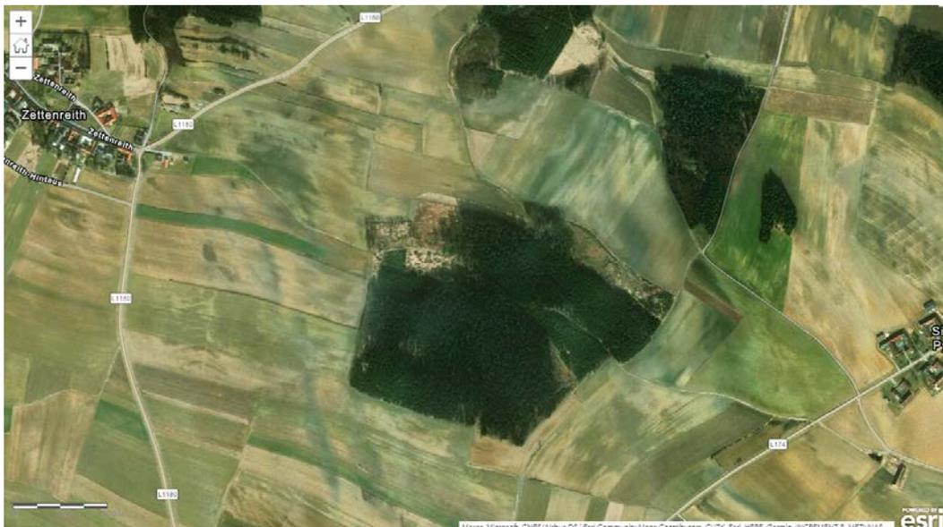
Abb. 31: Luftbildausschnitt aus dem Gebiet SE Zettenreith mit markanten dunklen Bodenfärbungen im Bereich oberflächlich ausbeißender Grafitlinsen (Quelle: ESRI World Imagery)
