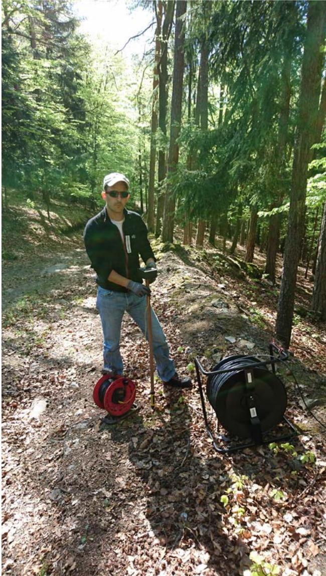
Abb. 70: Einsatz der mitgeführten Eigenpotenzialsonde bei der flächigen Aufnahme von SP
