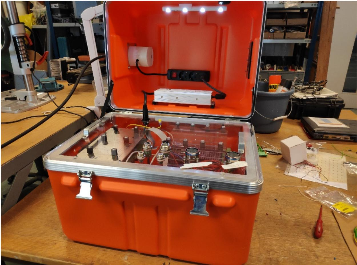
Abb. A1: neu entwickeltes geoelektrisches Messgerät GEOMON4D-IP (Stand Sommer 2020)
