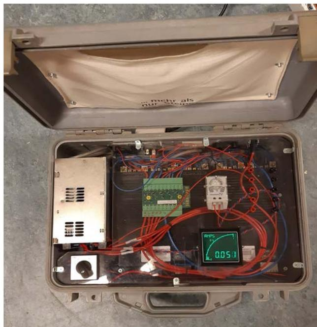
Abb. 71: neu entwickelte Einheit zur Stromeinspeisung für die Mise-à-la-Masse Methode
