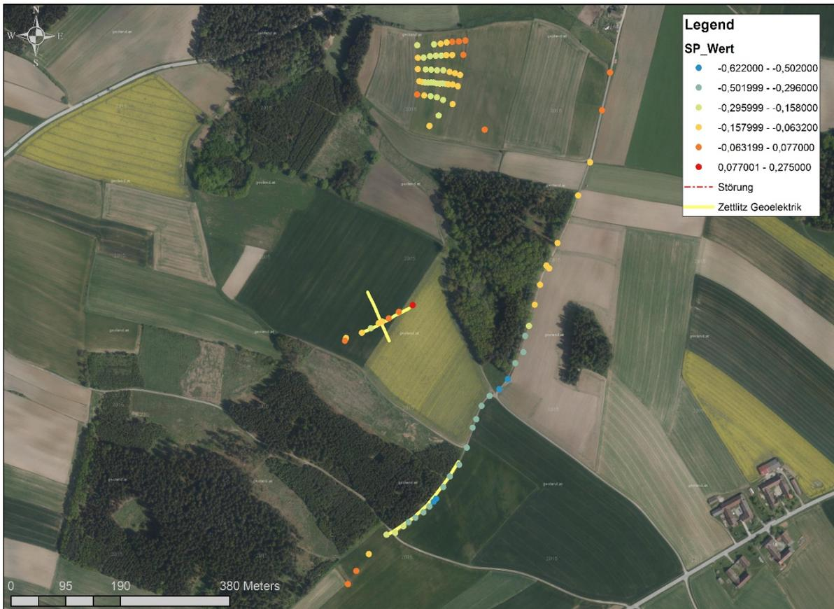
Abb. 38: Lageplan der SP-Messpunkte und der geoelektrischen Messprofile im Bereich der beiden südlichen Untersuchungsgebiete
